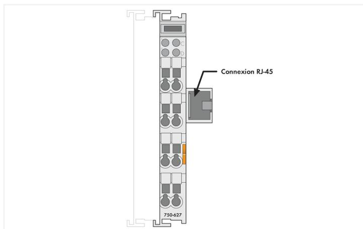
La borne de prolongation de bus interne 750-627 se monte à la fin du bornier comme la borne finale de bus 750-600. La station est fermée par cette borne et permet de raccorder un câble de liaison muni d'un connecteur RJ-45.
