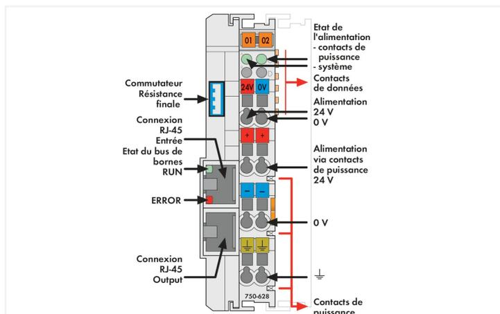
La borne coupleur de prolongation de bus interne 750-628 remplace le coupleur ou le contrôleur en tête de bornier. Il est la partie opposée de la borne d'extrémité 750-627. Le câble de raccordement est branché dans le connecteur femelle RJ-45 supérieur et constitue ainsi, avec la borne d'extrémité 750-627, la connexion logique au contrôleur/coupleur de bus de terrain.
