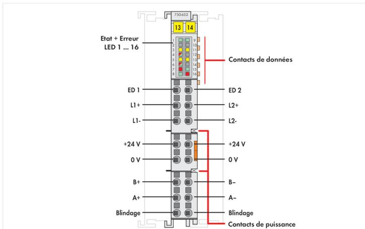
La borne pour vanne proportionnelle 750-632 sert à la commande de 2 vannes à bobinage simple jusqu'à 24 V/1,6 A ou d'une vanne jusqu'à 24 V/2 A. La borne dispose de 2 sorties PWM\* régulées en courant avec dithering commutable.
