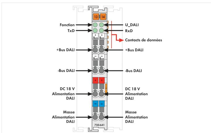
Le regroupement des fournisseurs autour d'un Standard DALI (CEI60929) a pour but, d'obtenir une interopérabilité dans le pilotage des ballasts électroniques, dans le domaine de l'éclairage. Ce nouveau standard remplace l'interface de gradation analogique 1 V- ... 10 V.
