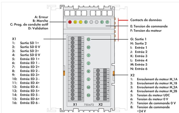
La référence 750-672 est un contrôleur de moteur pas à pas avec un étage de puissance individuel pour l'activation des moteurs pas à pas à biphasés jusqu'à 70 V/7,5 A.
