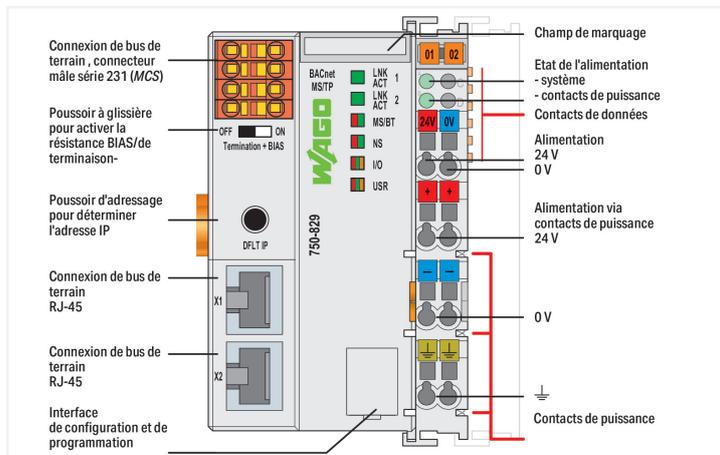
Le contrôleur BACnet MS/TP, réf. 750-829, permet de connecter les modules WAGO-I/O-SYSTEM au protocole BACnet. Le 750-829 remplit les exigences du profil de dispositif BACnet B-BC selon la norme DIN EN ISO 16484-5. La communication avec d'autres dispositifs BACnet se fait par BACnet MS/TP.
