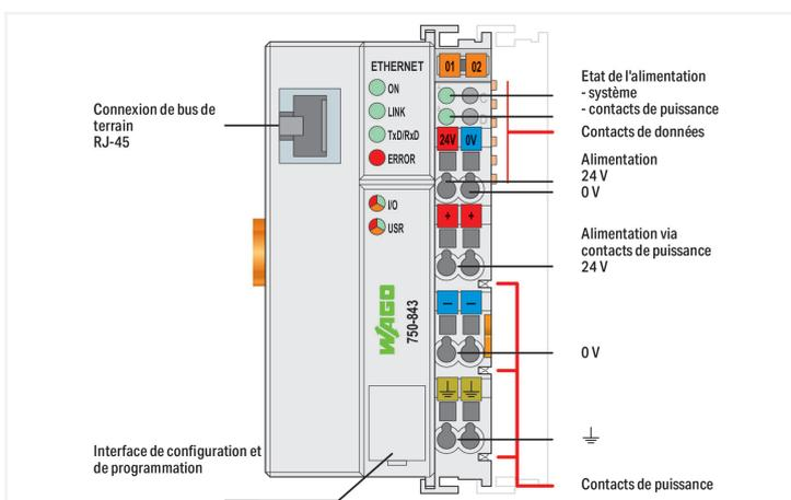
Le contrôleur ETHERNET combine la fonctionnalité de commande, de couplage E/S et d'ETHERNET dans un seul appareil.
