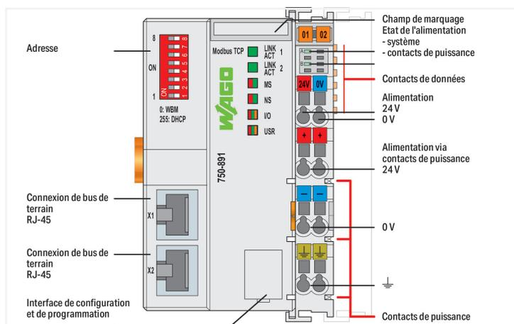
En combinaison avec le WAGO-I/O-SYSTEM, il est possible d'utiliser le contrôleur Modbus TCP en tant qu'automate programmable dans des réseaux EHERNET.
