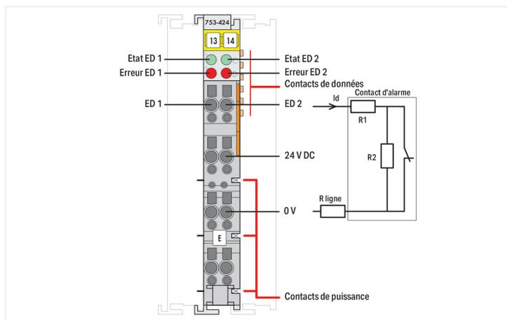
La borne est construite sous la forme d'une boucle de courant. Ainsi, la surveillance des contacts d'alarme (bris de fenêtre) avec un jeu de résistance fixes (R1, R2) est assurée.
