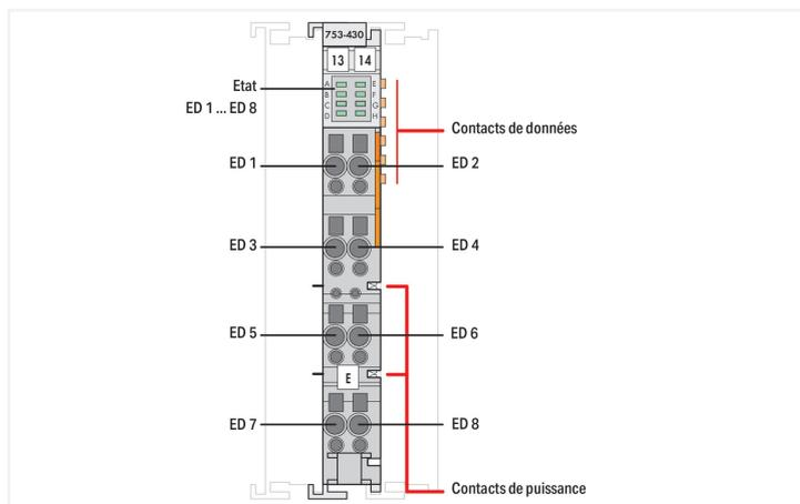
Cette borne d'entrées digitales (T.O.R.) de seulement 12 mm de largeur dispose de 8 canaux. Elle permet de raccorder des capteurs et des contacts secs.
