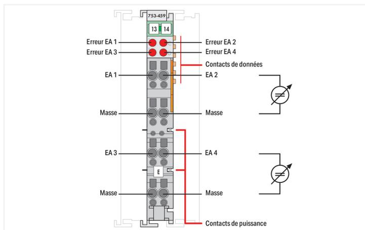
La borne d'entrées analogiques traite des signaux sur une plage standardisée 0 ... 10 V.
