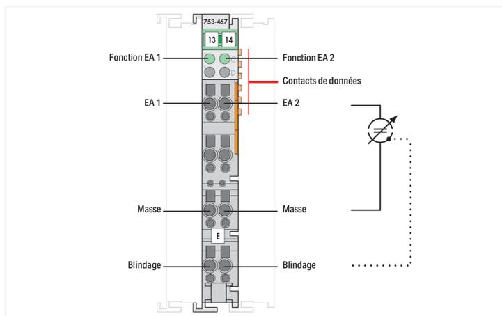
La borne d'entrées analogiques traite des signaux sur une plage de tension standardisée de 0 ... 10 V.
