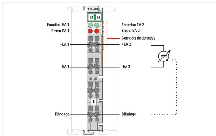
La borne d'entrées analogiques traite des signaux différentiels sur une plage de tension de  $\pm 10$  V DC.
