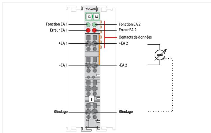
Cette borne de 2 entrées analogiques traite des signaux différentiels sur une plage de courant standardisée de 0 ... 20 mA.
