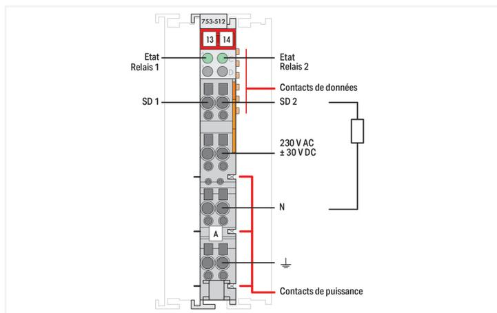
L'automate programmable transmet ses signaux de commande aux actionneurs connectés par l'intermédiaire des bornes de sorties digitales. La commande du ou des relais dépend de l'environnement interne.
