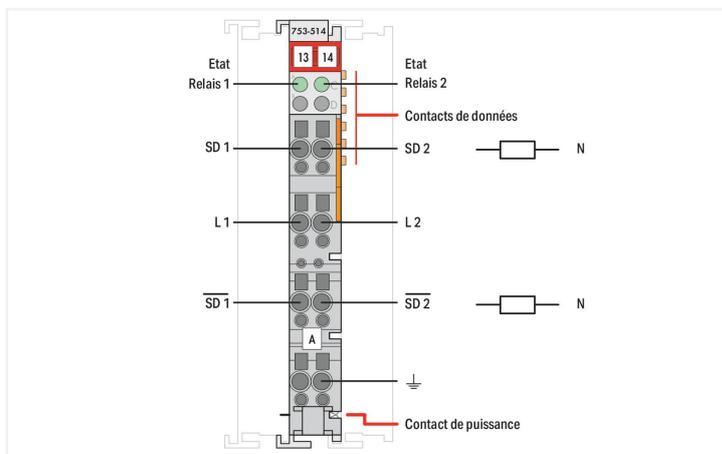
L'automate programmable transmet ses signaux de commande aux actionneurs connectés par l'intermédiaire des bornes de sorties digitales. La commande du ou des relais dépend de l'environnement interne. Les 2 relais 1 T sont isolés. L'état du relais est signalé par une diode LED.
