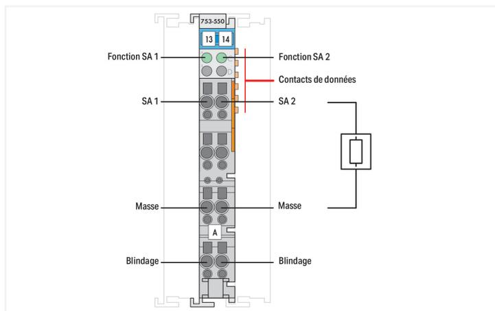
La borne de sorties analogiques génère des signaux analogiques sur une plage de tension standardisée de 0 ... 10 V. Le signal de sortie est séparé galvaniquement et le transfert au coupleur se fait sur une unité d'adressage de 12 bits. Les sorties sont protégées contre les courts-circuits. Pour l'alimentation, la tension interne est utilisée pour le module d'alimentation. Les canaux des bornes de sorties possèdent un potentiel de référence commun.
