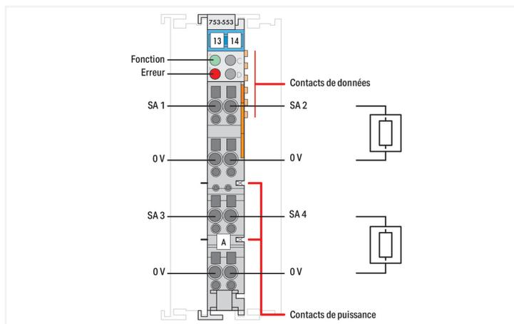
La borne de sorties analogiques génère des signaux analogiques sur une plage standardisée de 0 ... 20 mA.
