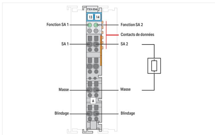
La borne de sorties analogiques génère des signaux analogiques sur une plage de tension standardisée de  $\pm 10$  V.
