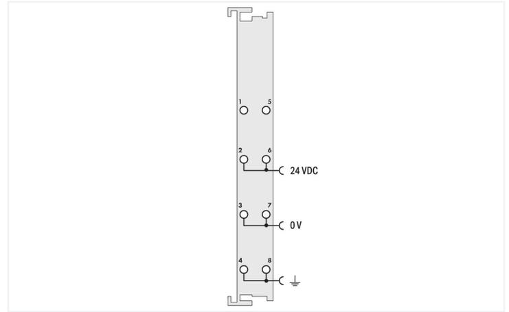
Cette borne d'alimentation alimente les diverses bornes de bus de terrain par les contacts de puissance.
