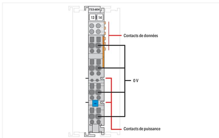
Cette borne de distribution de polarités, en combinaison avec la borne de sorties à 8 canaux réf. 750-530, met à disposition 8 points de connexion 0 V.
