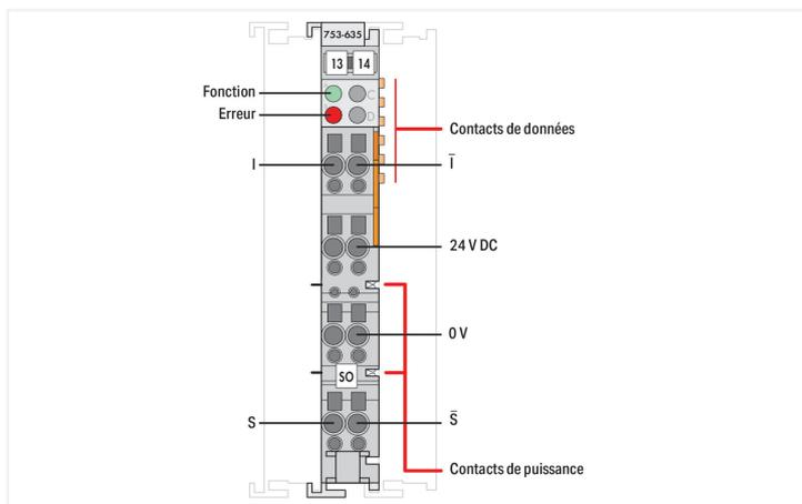
L'interface d'impulsion digitale permet de raccorder des capteurs de mesure de déplacement (guide d'onde magnétostrictif) avec interface de départ/arrêt. Ces capteurs reçoivent une impulsion et renvoient comme réponse une impulsion retardée, dont le retard est proportionnel à la distance du capteur.
