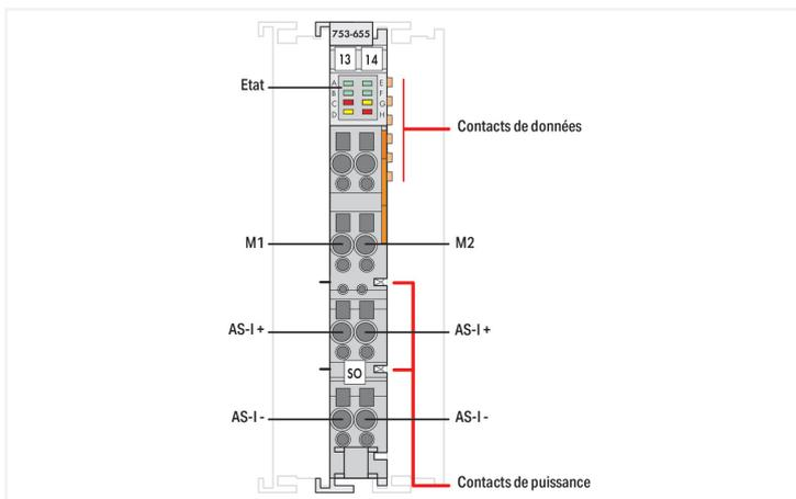
La borne maître AS-Interface 75x-655 permet de raccorder le réseau AS-Interface à un autre bus de terrain. Elle se comporte en tant que maître pour le bus AS-Interface et en tant qu'esclave pour le bus de terrain supérieur. La borne maître AS-Interface 75x-655 est un maître M4 selon la spécification AS-Interface V3.0.
