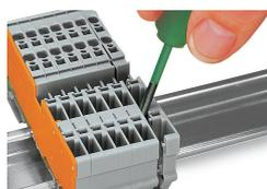
Séparer les bornes grâce à l'outil de manipulation, faire glisser la borne sur le côté et l'ouvrir par la fente de démontage.
