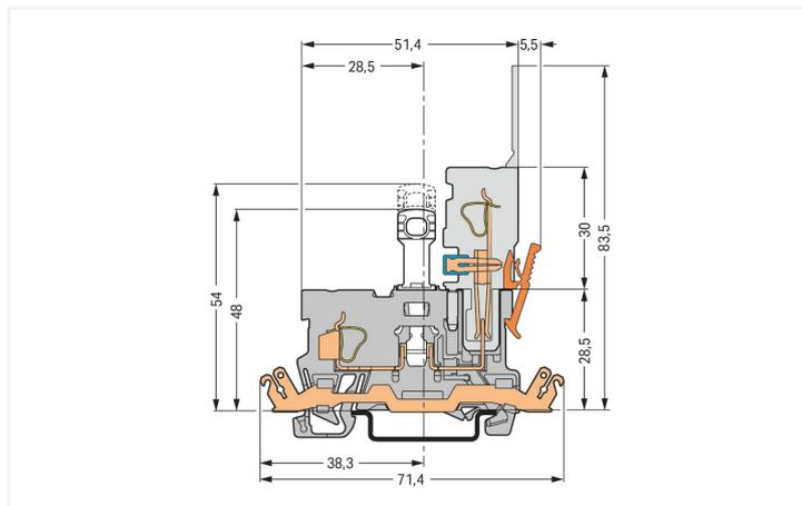
Borne de base sectionnable ; avec rail de contact pour continuité de blindage
