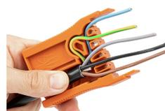
Placer le câble dénudé dans la matrice pour le raccordement, puis disposer les fils dans leur position définitive en commençant par le neutre conformément au marquage.
