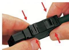
Clipser le boîtier de décharge de traction.
