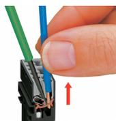
Pour le démontage du conducteur, actionner le ressort de serrage à l'aide d'un tournevis dont la largeur de lame est de 2,5 mm et retirer le fil.
