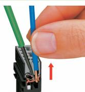
Pour le démontage du conducteur, actionner le ressort de serrage à l'aide d'un tournevis dont la largeur de lame est de 2,5 mm et retirer le fil.
