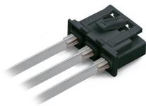
Il est très économique de monter les connecteurs d'appareil dans les rainures de guidage d'un boîtier. La connexion électrique interne est réalisée par les contacts à fourche avec le rail de 0,8 mm d'épaisseur.
