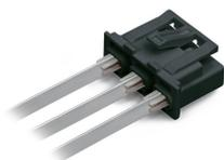
Il est très économique de monter les connecteurs d'appareil dans les rainures de guidage d'un boîtier. La connexion électrique interne est réalisée par les contacts à fourche avec le rail de 0,8 mm d'épaisseur.
