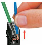
Actionner le ressort de serrage à l'aide d'un outil de manipulation dont la largeur de lame est de 2,5 mm et introduire le fil dénudé jusqu'en butée pour raccorder des conducteurs souples.
