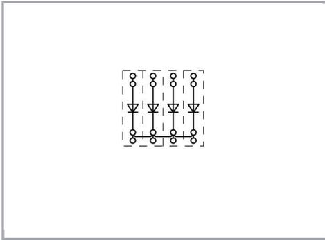
Bornes pour réaliser des ensembles de diodes avec cathode commune :
