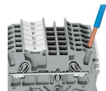
**Raccordement du conducteur – insertion directe.**
