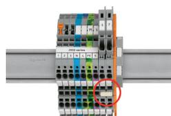
Pour les bornes à fusible au pas de 6,2 mm, une plaque intercalaire fait partie de la borne et est livrée en série. L'utilisation de la gamme de contacts de pontage de la série 2004 est nécessaire pour les bornes à deux étages avec plaque d'extrémité en raison du pas de 6,2 mm.
