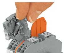
Une plaque d'extrémité pour borne à fusible (ici orange, 2002-1092) sert de protection supplémentaire contre l'ouverture du porte-fusible. Le remplacement de fusible ne peut se faire que lorsque le porte-fusible a été déconnecté du circuit.
