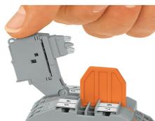
La borne à fusible à deux étages avec porte-fusible pivotant (2002-2611, gris) est combinable avec les bornes sectionnables, de passage et de protection. Le porte-fusible est aussi disponible avec témoin de fusion à LED (par ex. 2002-2611/1000-541 pour 12 ... 30 V).
