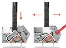
Connexion du conducteur : Sectionnement direct du ressort à l'aide d'un outil de manipulation ou déplacer le curseur d'actionnement vers l'ouverture d'introduction du conducteur. Introduire le conducteur dénudé jusqu'à la butée et remettre le curseur d'actionnement dans sa position de départ (l'actionnement est aussi possible sans outil, à l'aide de l'ongle).
