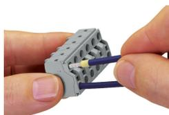
Les conducteurs rigides et les conducteurs souples  $\geq 0,5 \text{ mm}^2$  munis d'embout d'extrémité sertis peuvent être insérés directement. Via les ouvertures de test, on peut réaliser un contact direct avec des broches de test.
