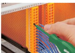
Connecteur femelle à 16 pôles avec brides de fixation dans un insert 19"; raccordement du conducteur - actionnement dans la direction de connexion du conducteur.
