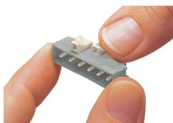
Détrompage d'un connecteur mâle – encli-
