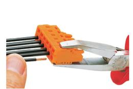
Raccordement du conducteur à l'aide de l'outil de manipulation
