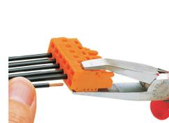
Raccordement du conducteur à l'aide de l'outil de manipulation
