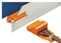
Grâce au modèle de construction des brides, les surfaces habituelles ainsi que les différentes applications traversantes sont possibles. Selon le type d'application et le type de bride, un connecteur femelle peut être monté soit au travers d'une paroi de boîtier ou de manière plane avec cette dernière.
