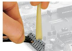
Raccordement des conducteurs, avec outil de manipulation
