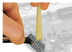
Raccordement des conducteurs, avec outil de manipulation
