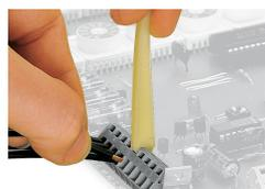
Raccordement des conducteurs, avec outil de manipulation
