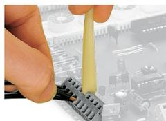
Raccordement des conducteurs, avec outil de manipulation
