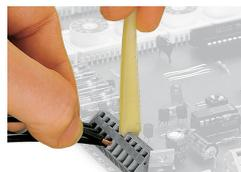
Raccordement des conducteurs, avec outil de manipulation
