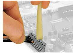
Raccordement des conducteurs, avec outil de manipulation
