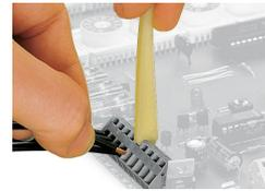
Raccordement des conducteurs, avec outil de manipulation
